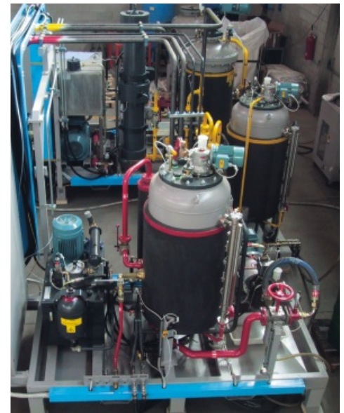
Ligne SoliSpray: machine haute pression couplée à une unité de dosage pour composants chargés
